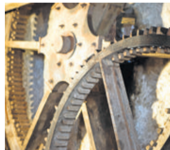
Détail du train de surmultiplication de la roue.
