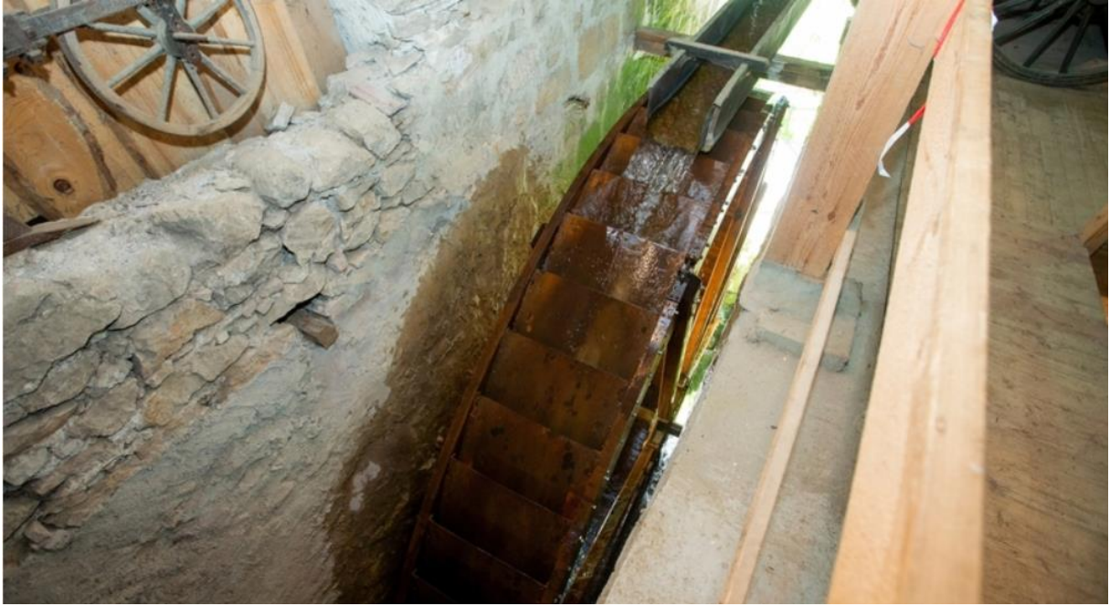
C'est le poids de l'eau qui fait tourner la grande roue à augets d'un diamètre de six mètres cinquante.
